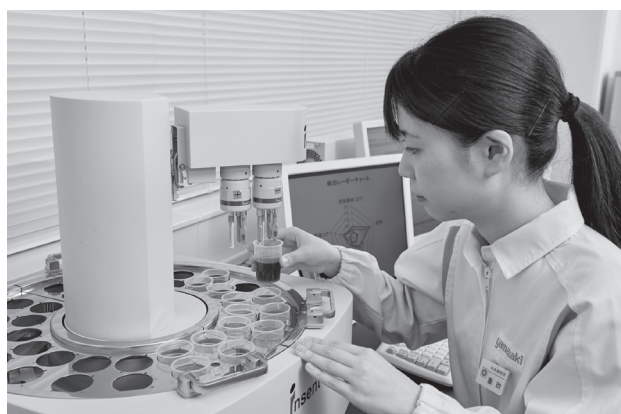
写真2 味覚センサーで旨味や酸味などを測定（中央研究所） Measuring specific taste such as umami and acidity using taste sensor
