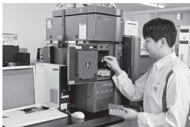
写真3 液体クロマトグラフで糖組成を測定（中央研究所） Measuring sugar composition using liquid chromatograph
