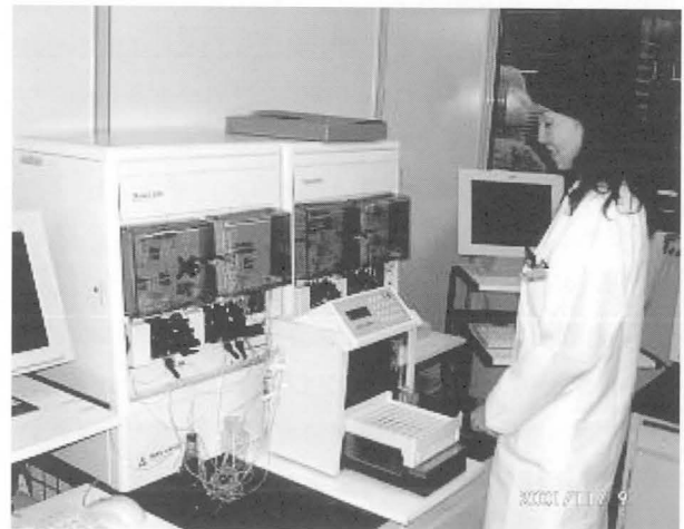
図3 オートアナライザ(TRAACS) Figure 3 Autoanalyzer (TRAACS)
